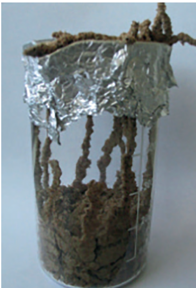
Jedno powtórzenie w procedurze badawczej wg ASTM D 2245-08 – widoczne rurki z ziarenek substratu i odchodów termitów (tzw. galerie)
