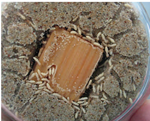
Jedno powtórzenie w procedurze badawczej wg ASTM D 2245-08 – widoczne na dnie pojemnika termity niszczące próbkę bielu sosny zwyczajnej pograżoną w piasku
