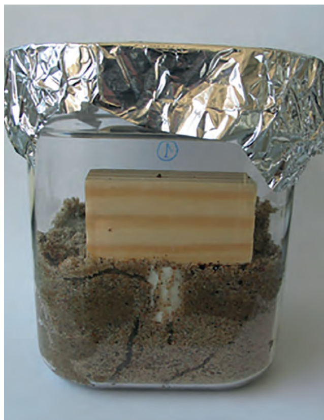
Jedno powtórzenie w procedurze badawczej wg PN-EN 117 widoczna próbka drewna ponad poziomem piasku i korytarze termitów
