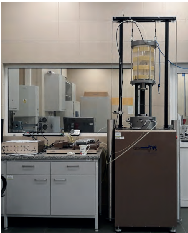
Cylindryczny aparat skrętny do badań próbek gruntu w złożonym stanie naprężenia – Centrum Wodne SGGW
